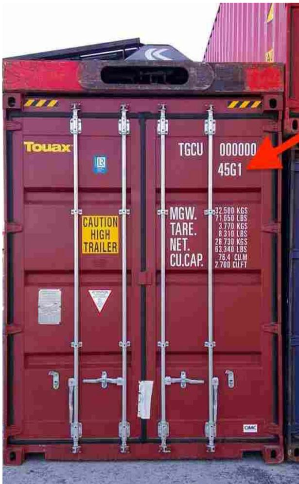
Les conteneurs ISO doivent être marqués conformément à la norme ISO 6346. Cette norme exige que les conteneurs soient marqués d'un code « Taille » à deux chiffres et d'un code « Type » à deux chiffres. [Voir la flèche à gauche]
