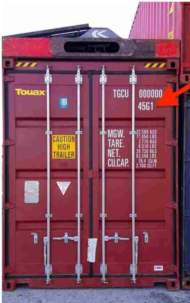
Los contenedores ISO deben marcarse de manera que cumplan con la norma ISO 6346. Esa norma requiere que los contenedores estén marcados con un código de "Tamaño" de dos dígitos y un código de "Tipo" de dos dígitos. [Ver flecha a la izquierda]
