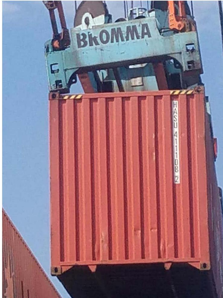
Cuando conecte contenedores con cualquier dispositivo esparcidor, verifique las luces de la consola de su equipo y obtenga una indicación sobre el acoplamiento del cierre giratorio. Luego, solo para estar seguro, realice un levantamiento de prueba y flote la carga. Al levantar contenedores, estar encerrado en tres esquinas no es suficiente. Los contenedores están diseñados para levantarse verticalmente; desde las cuatro esquinas.
