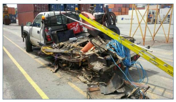
Ayer, en Halifax, Nueva Escocia, un trabajador aparentemente no pensó muy bien al estacionar la camioneta que manejaba en el paso de un RTG. Los resultados son obvios..., y completamente evitables... Para empeorar las cosas, ila camioneta estaba estacionada en el punto ciego del RTG!
